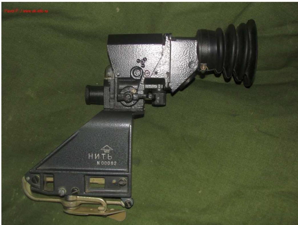
Прицел может эксплуатироваться при температуре окружающего воздуха от минус 50°С до плюс 50°С и относительной влажности воздуха 98% при температуре 25 С. По живучести и стойкости к внешним воздействиям прицел соответствует группе 1.14 по ГОСТ В20.39.304-76, климатического исполнения УХЛ. По показателям надежности прицел соответствует требованиям категории А группы 11 по ГОСТ В20.39.303-76.
